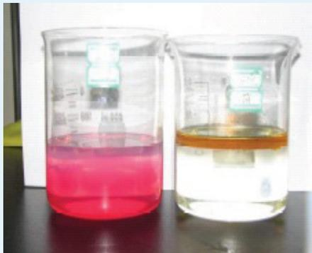
Eine HFC Flüssigkeit vermischt sich vollständig mit Wasser (linker Becher). Die Entfernung der organischen Belastung aus dem Wasser benötigt extensive chemische Verfahren sowie hohe CSBBelastung des Abwassers. HFD-U Flüssigkeiten sind leicht von Wasser zu trennen (rechter Becher).
