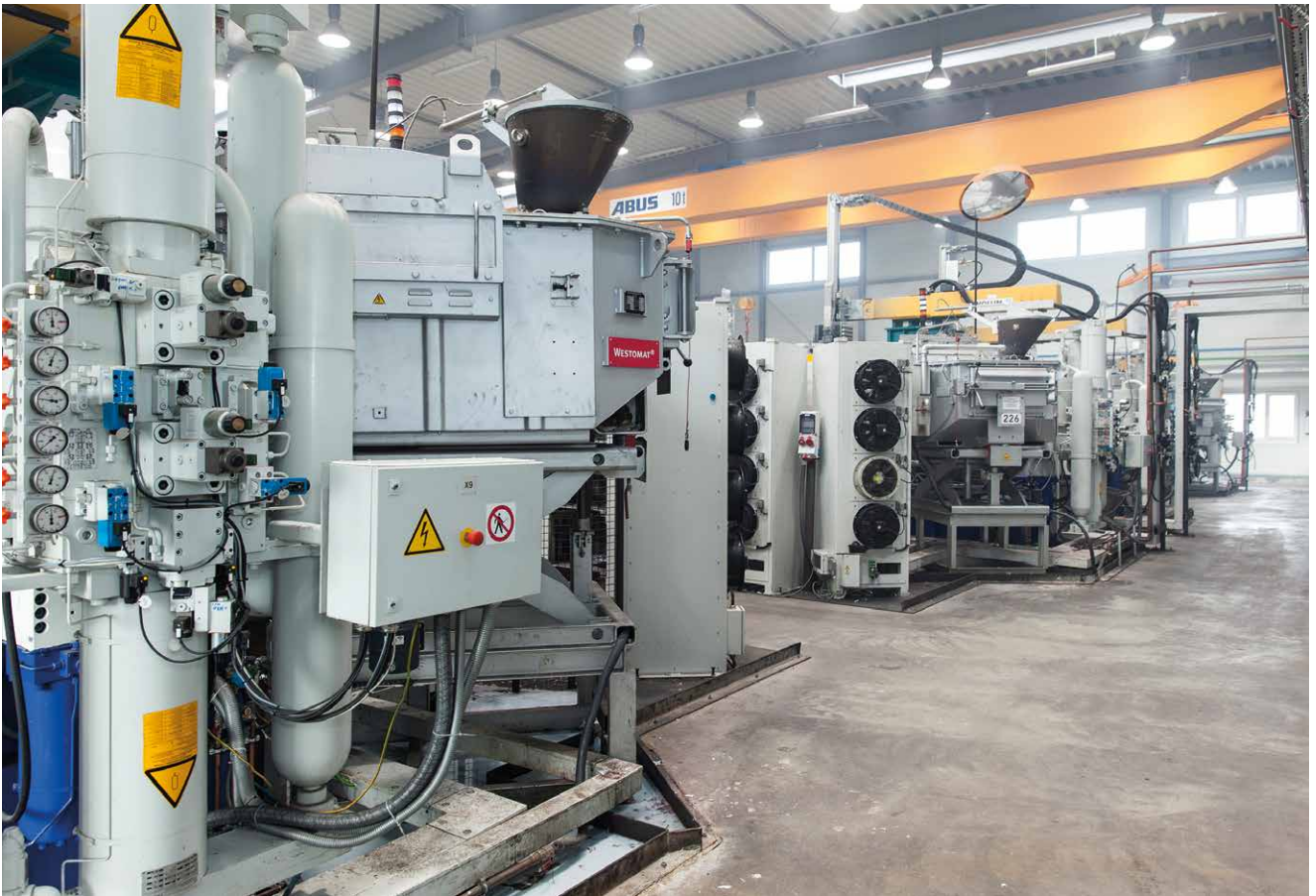
Beim Druckgießen ist die Schwerentflammbarkeit entscheidend für die Auswahl der Hydraulikflüssigkeit.
